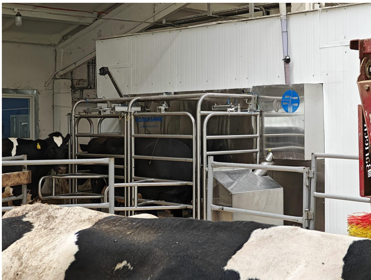
Рисунок 10 – Размещение роботизированной доильной станции «Волшебник» в производственном помещении с системой доступа животных
