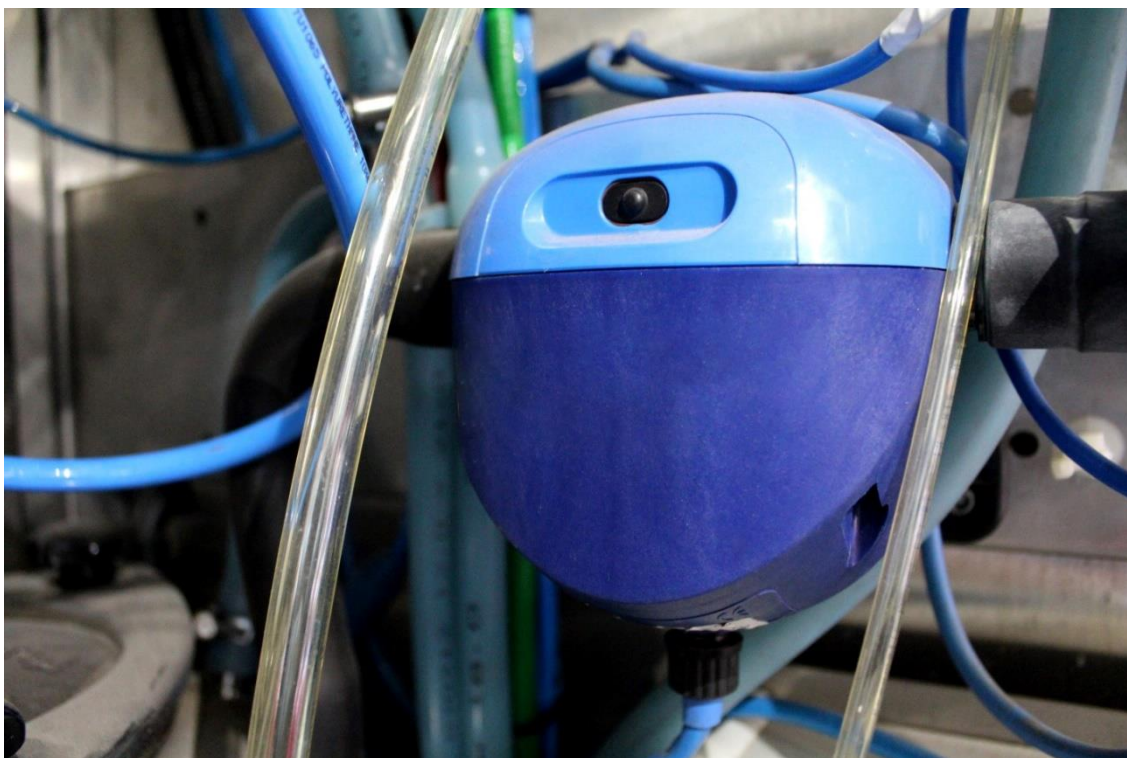
Рисунок 20 - Сенсорный узел автоматического определения положения вымени в составе роботизированного доильного комплекса
