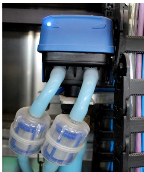
Рисунок 15 – Пульсатор доильной установки
