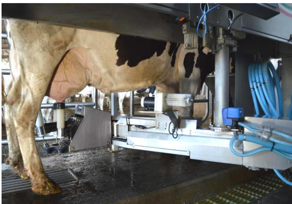
Рисунок 12 - Рабочее положение дойной коровы в боксе роботизированной доильной станции: этап позиционирования вымени и подключения доильных аппаратов
