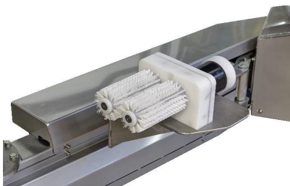
Рисунок 16 - Автоматизированный модуль очистки и массажа вымени: блок ротационных щёток для преддоильной обработки сосков
