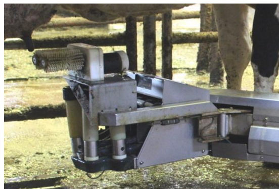
Рисунок 16 - Автоматизированный модуль очистки и массажа вымени: блок ротационных щёток для преддоильной обработки сосков
