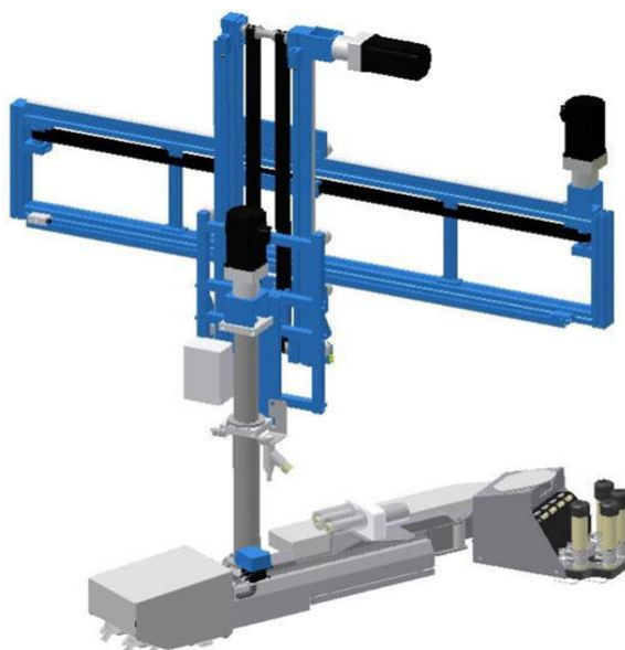
Рисунок 13 - Манипулятор роботизированной доильной установки «Волшебник» с системой позиционирования
