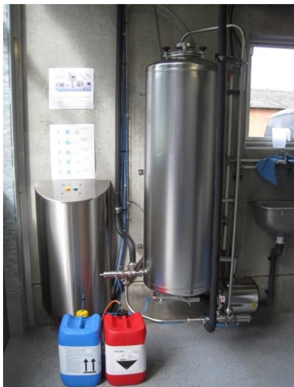
Рисунок 23 - Узел санитарной обработки: накопительная ёмкость, блок подогрева и дозаторы химических реагентов в составе системы автоматической мойки
