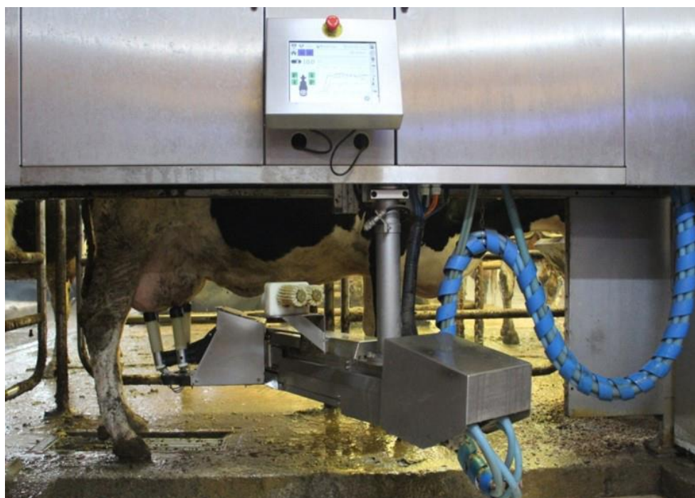
Рисунок 14 - Процесс автоматического доения коровы на роботизированной установке «Волшебник»: вид на панель управления, манипулятор и доильные аппараты
