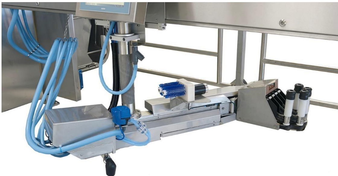
Рисунок 7 - Исполнительные механизмы роботизированной доильной установки «Волшебник»
