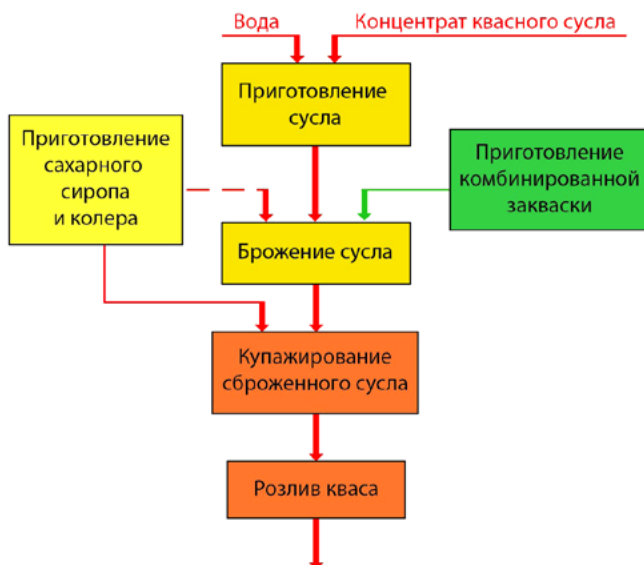
Рисунок 2. Схема технологического процесса производства кваса
