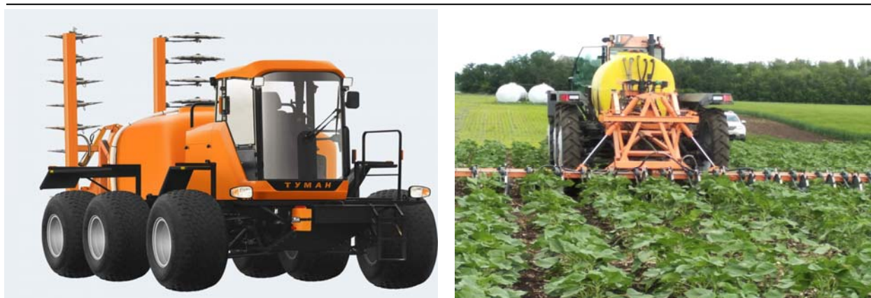
Рис.4. Комплекс «Туман» с технологическими модулями: а)-разбрасыватель для гранулированных удобрений; б)-опрыскиватель с крупнокапельными форсунками и удлинительными шлангами для внесения жидких удобрений КАС поверхностно; в)-мульти-инжектор для внутрипочвенного-инъекционного внесения жидких минеральных удобрений; г)- мультиинжектор на подсолнечнике-фаза 5-й лист
