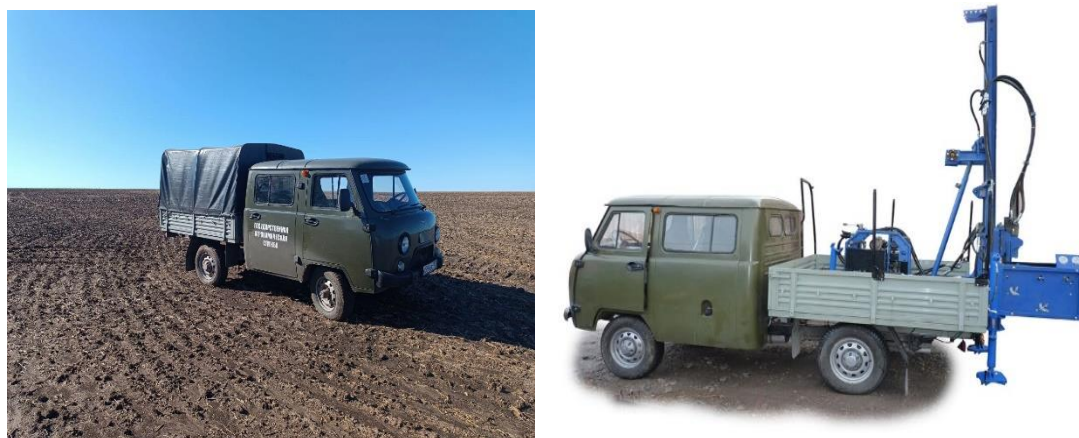
Рис. 1. Автоматический пробоотборник, установленный в автомобиле УАЗ «Фермер»
